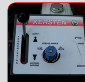
Stufenlos verstellbarer hydraulischer Fahrtrieb bei Vento Silent A
