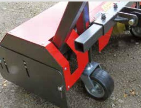
Stufenlose Höheneinstellung über die Laufräder
