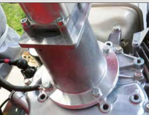
Wartungsfreie Zahnradpumpe mit Direktantrieb
