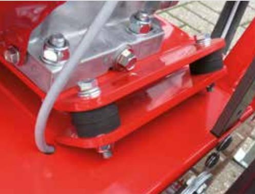
Vibrationsgedämpfter Motor für ermüdungsfreies Arbeiten.
