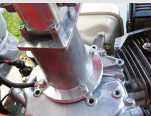
Wartungsfreie Zahnradpumpe mit Direktantrieb
