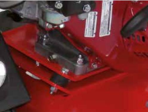
Vibrationsgedämpfter Motor für ermüdungsfreies Arbeiten.
