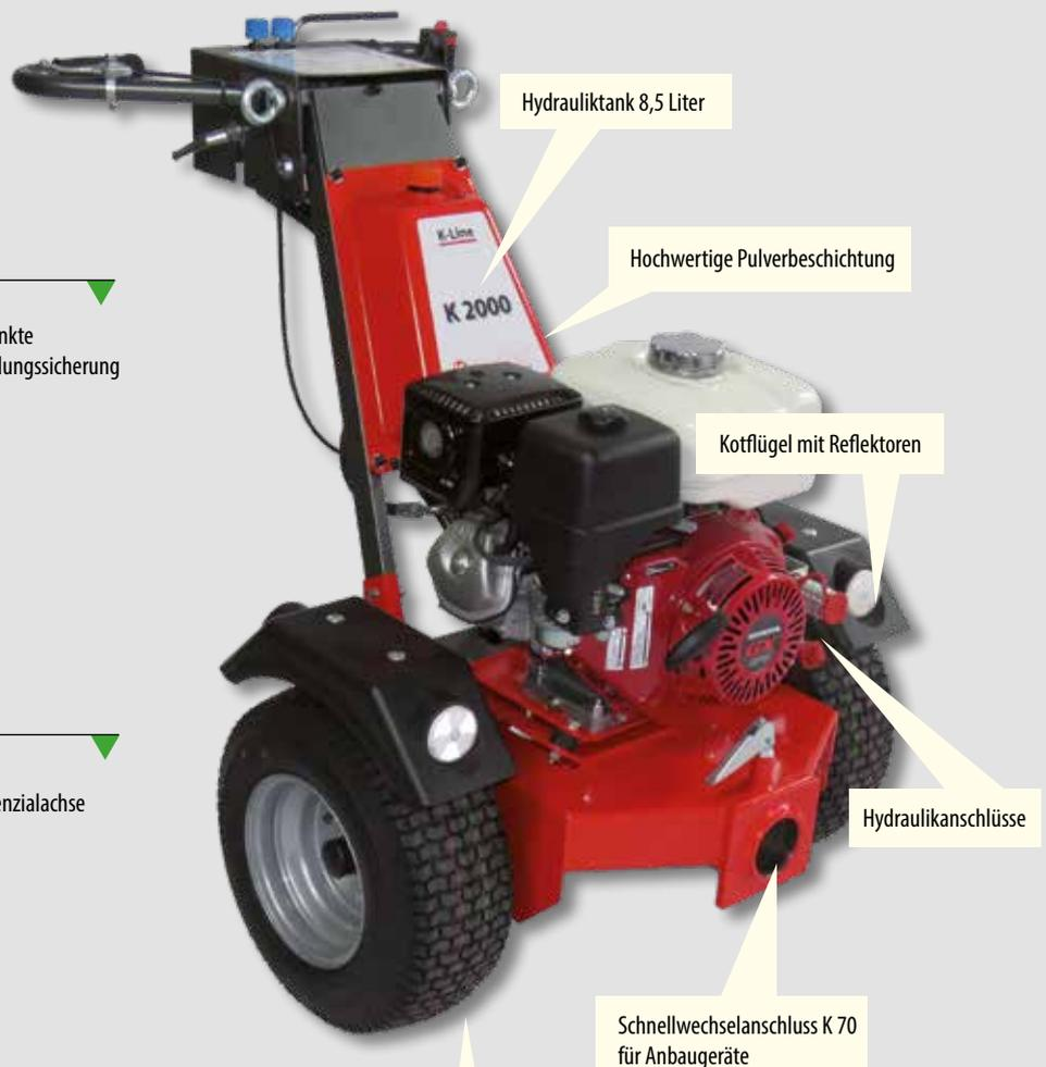
Bereifung, z. B. 16 x 6,5-8 Blockprofil
