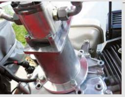
Wartungsfreie Zahnradpumpe mit Direktantrieb
