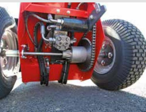
Hydrostatischer, Stufenloser Fahrtrieb mit Differenzialachse
