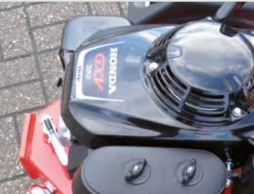
Leistungsstarker Honda-Industriemotor mit 4,4 PS (Nettoleistung)
