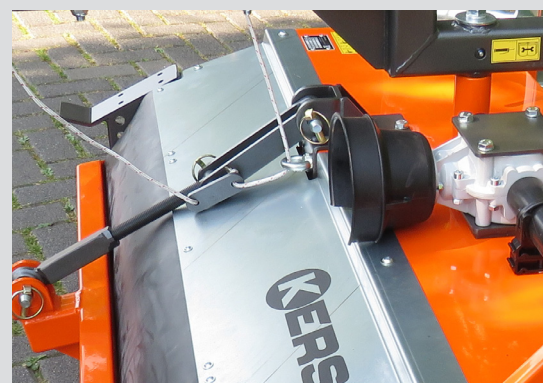
Mechanische Entleerung des Sammelbehälters (hydraulisch optional)
