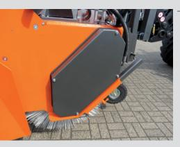
Antrieb über Duplex-Kette (selbstspannend/wartungsfrei)
