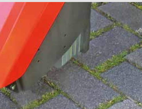
Zusatzgewichte für bessere Balance des Messerbalkens
