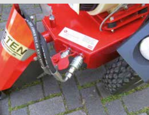
Verbindung der Hydraulik über Schnellsteckkupplungen
