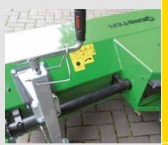
Geschützt eingebautes Getriebe für mechanische Kehrmaschine
