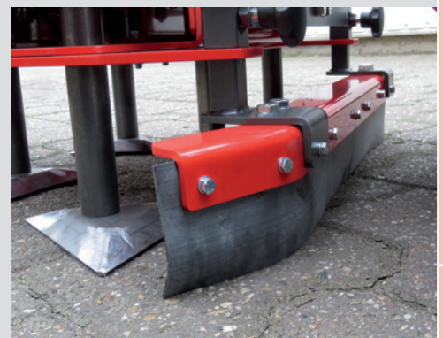
Gummituch zum Egalisieren des gelösten Bodens
