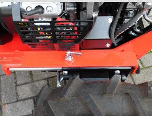
mechanische/hydraulische Achsverschiebung, um die Einheit auszubalancieren
