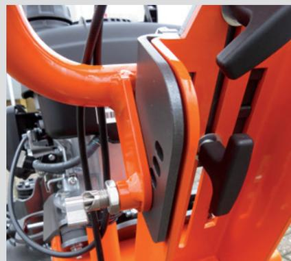
Durch den kurzen Abstand zwischen dem Wildkrautbürstenteller und der Achse einerseits und dem längeren Abstand zwischen Achse und Handholm andererseits entsteht durch die Hebelwirkung ein ausgewogenes Gewichtsverhältnis. Dadurch ist der Weedo extrem einfach zu handhaben und lässt sich auch sehr leicht nach links und rechts steuern.
