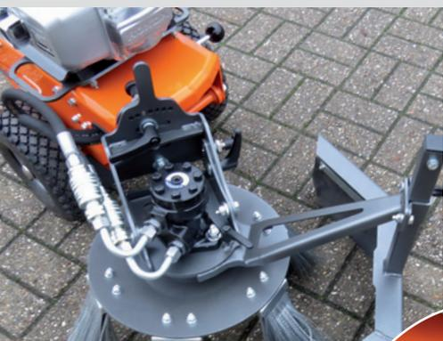
Bürstenteller in Fahrrichtung rechts oder links schwenkbar. Drehrichtung des Bürstentellers wahlweise links oder rechts, durch einfaches Umstecken der Hydraulikanschlüsse.
