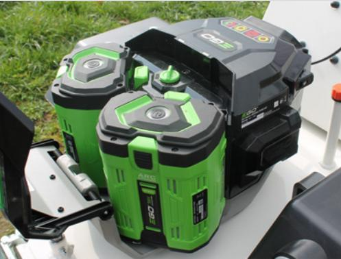
Zwei Batteriefächer am Motor, die Batterien können leicht ausgetauscht werden.
