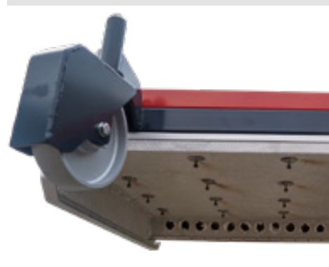
Düsenleiste und Wärmeisolierung
