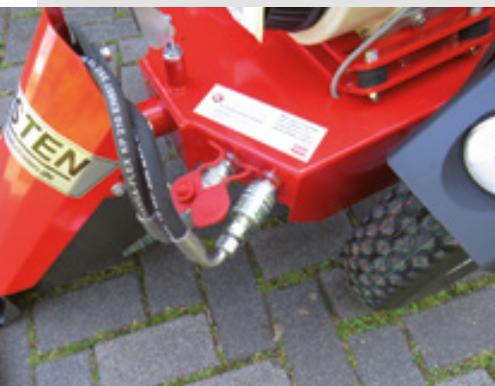
Verbindung der Hydraulik
