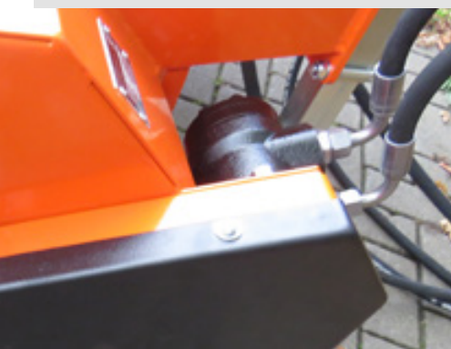
Geschützt positionierter Hydraulikmotor
