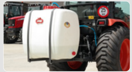
Wassersprengereinrichtung (WAS 100 KAT 1 / WAS 200 KAT 1)
