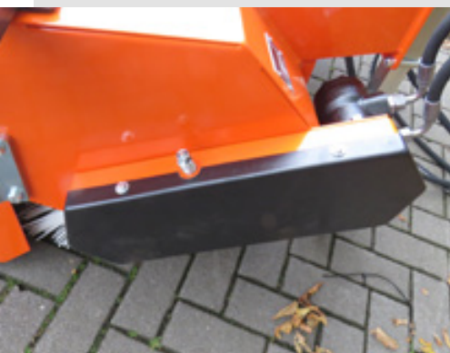
Kettenkasten mit wartungsfreiem Kettenspanner
