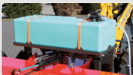
Wassersprengereinrichtung (WAS 100 AUF-KM 50)
