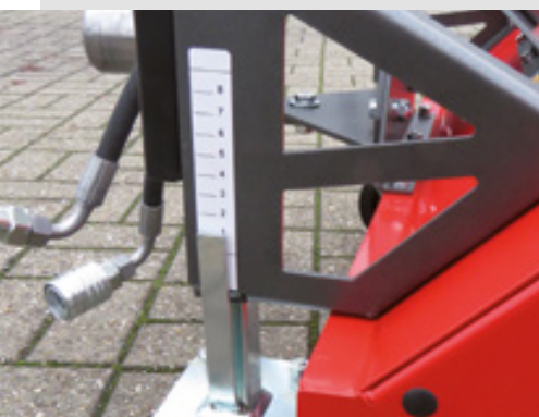
Stufenlose Höhenverstellung der Kehrwalze
