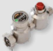
► Der Sicherheitsdruckregler ermöglicht es, die Heizleistung anzupassen und verfügt über eine Sicherheitsfunktion, die das Gas bei geringstem Leck auf der gesamten Schaltung sofort absperrt.
