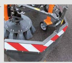
Mechanische oder hydraulische Winkelverstellung
