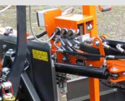
Hydraulikblock zur hydraulischen Verstellung der verschiedenen Arbeitswinkel
